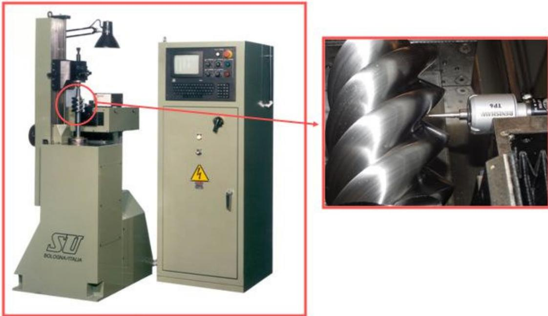
**Figura N°5-** *Controllo del rotore e trasmissione dei dati al CNC della macchina per l'eventuale correzione automatica degli errori*
